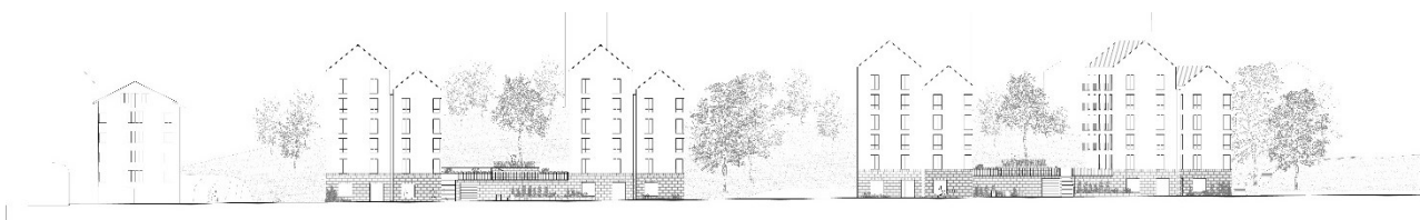
Figur 26. Illustration över hur planförslaget fortsätter det gavelmotiv som det befintliga lamellhuset mot Årstavägen påbörjar längs Tavelsjövägens början. De nya husen är rytmiskt placerade längs gatan med släpp emellan husen som utgörs av bevarad naturmark eller garagebyggnader i en våning med bostadsgårdar ovanpå. Bild: Arkitektstudio Witte.
