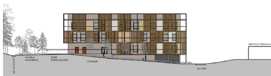
Bild 21. Fasadelevation (exempelbild), sett från Trollesundsvägen (nordväst). Inre konstruktion med indelad fasad med en variation av jordtoner. Yttre träkonstruktion med ribbverk som inte ska bemålas. (NIRAS)
