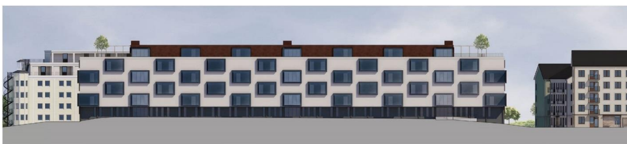
Nybyggnad: fasad mot E4/E20 Södertäljevägen. Fasad mot E4 ska utformas med inbyggd korridor med stora glaspazier. Takterrass med pergola och bullerskyddad glaspazier syns i bilden. Larsson Arkitektur AB.
