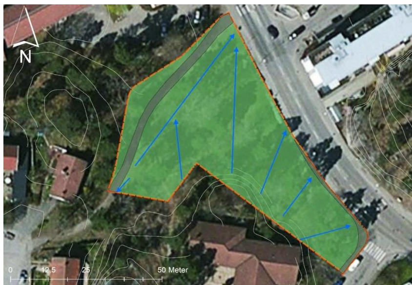
Översiktskarta som visar vattenavrinning. De blå pilarna visar de naturliga flödesriktningarna för avrinnande dagvatten. Bild: Geosigma.
