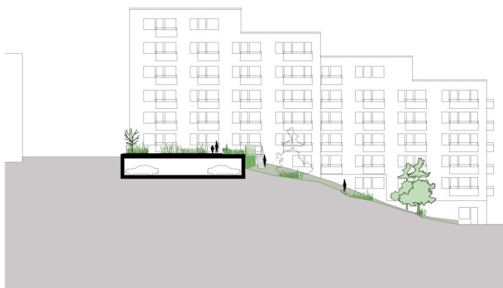
Terrasserade lamellhus med garage. Längdsektion. (Joliark)
