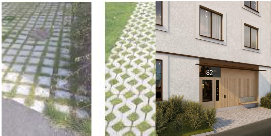
Referensbilder på betonggräs som exempel på genomsläppligt material. Parkeringsytorna för bil och cykel utförs i genomsläppligt material enligt ambitionen att minska de hårdgjorda ytorna. (White Arkitekter)
