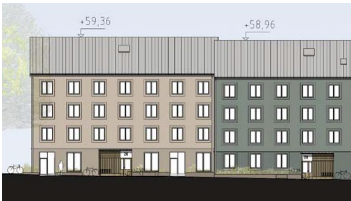
Fasadutsnitt mot Folkparksvägen. En del av byggnaden mot Folkparksvägen närmast korsningen får högre våningshöjd, bjälklag i samma nivå som gångbanans marknivå och höga fönster och fönsterdörrar huvudsakligen av glas i bottenplan mot gata.
