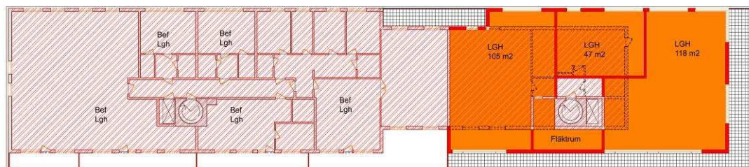
Våningsplan 11, den röda skrafferade markeringen visar befintliga bostäder samt ventilations- och förrådsutrymen, den orangea visar tillkommande bostäder. (Selander Ax Arkitekter AB)
