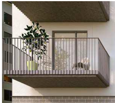
Balkong med pinnräcke. Den kan även utföras med perforerad korrugerad plåt. Balkongplattan i betong får en ursparning i framkant så att den upplevs nättare. (Bild White arkitekter)
