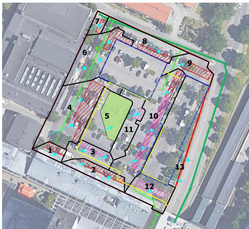
Placering av dagvattenanläggningar allmän platsmark i form av skelettjordar och översilningsyta/gräsyta. Ytlig avvattning illustreras med blå pilar. (Ramboll)
