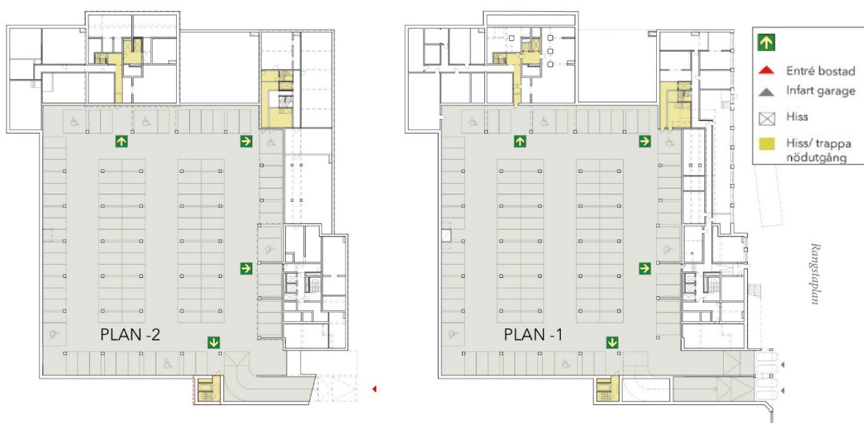
Principbild som visar garagelösning och funktioner. Nedre garageplan (plan -2) till vänster och övre garageplan (plan -1) till höger. (Dinell-Johansson)
