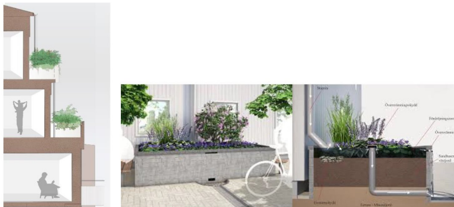
Principförslag på växtbädd på terrass och på gård (Bild. Total arkitektur och Sundbybergs stad).
