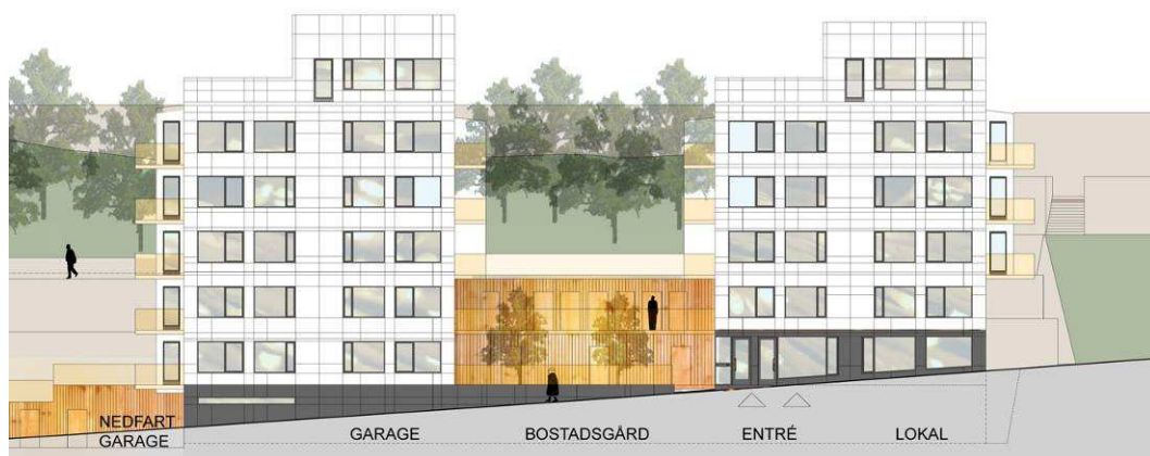
Fasadutsnitt som visar fasadutformning med stödmur och sockel i natursten och förrådslängornas träfasad
