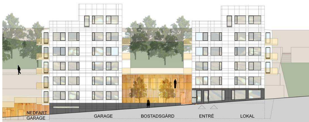
Fasadutsnitt som visar fasadutformning med stödmur och sockel i natursten och förrådslängornas träfasad
