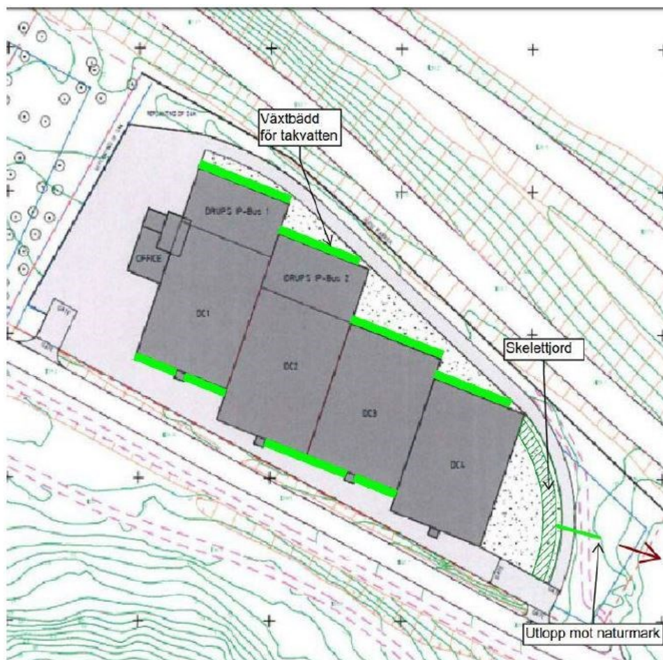
Figur 4 Åtgärdsförslag för dagvattenhantering. Upphöjda växtbäddar för takvatten är markerade med gröna ifyllda partier, och skelettjord för hantera vatten från hårdgjorda ytor är markerad med en grön streckad färg. Ledning med utlopp mot naturmark visas i grönt, där pilen anger flödesriktningen.
