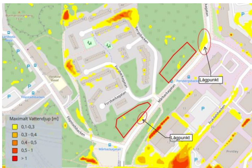
Maximalt vattendjup utifrån Stockholms stads skyfallsmodellering. Planområdenas ungefärliga placering markerat i rött. (Sweco 2021)
