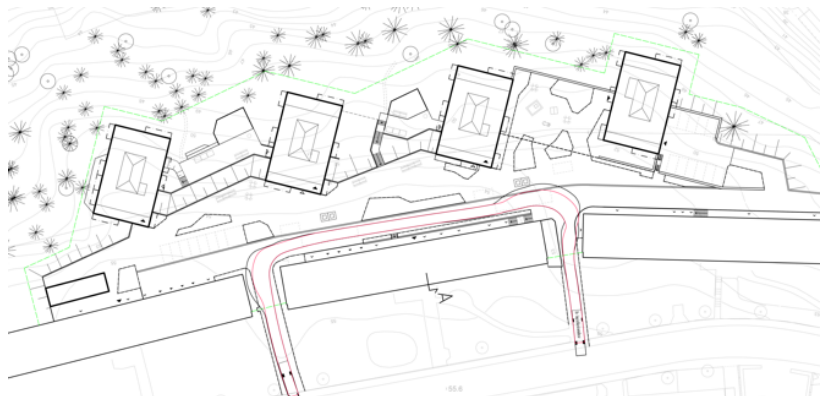
Bilden visar studie med körspår för sopbil som är 12 meter lång. Bild: Landskapslaget
