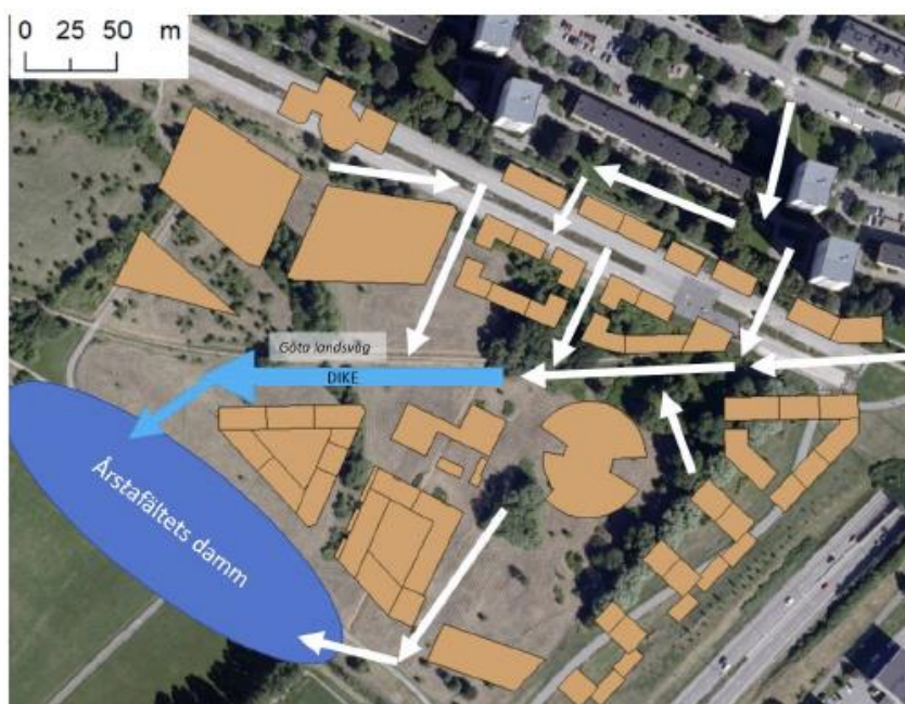
Skyfallsprinciper inom Årstafältets Etapper 4a och 4b. Skyfallet leds via ett dike till dammen som ligger centralt på Årstafältet. Höjdsättningen inom planområdet är anpassat för att kunna leda skyfallsvattnet till dammen.
