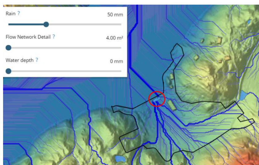
Översvämningsrisk vid 50 mm regn för befintliga marknivåer. Vattensamling inom planområdet är markerad med röd cirkel. Bild: ÅF/Trafikverket, 2021
