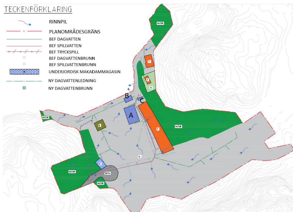
Föreslagen dagvattenhantering inom planområdet. Utsnitt från upprättad dagvattenutredning. Bild: ÅF/Trafikverket, 2021
