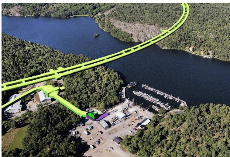
Bild som illustrerar tunnelsystemet för del av Förbifart Stockholm, under marknivå, i ljusgrön färg. Föreslaget brandgasschakt samt betongtunnel illustreras i grön färg. Bild: Trafikverket
