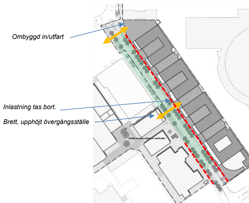
Illustration över Arenavägen som visar föreslagna åtgärder. Gatan sänks inom grönmarkerat område. Gula pilar visar övergångsställen. Röd streckad linje visar utfartsförbud i detaljplanen. Bild SBK
