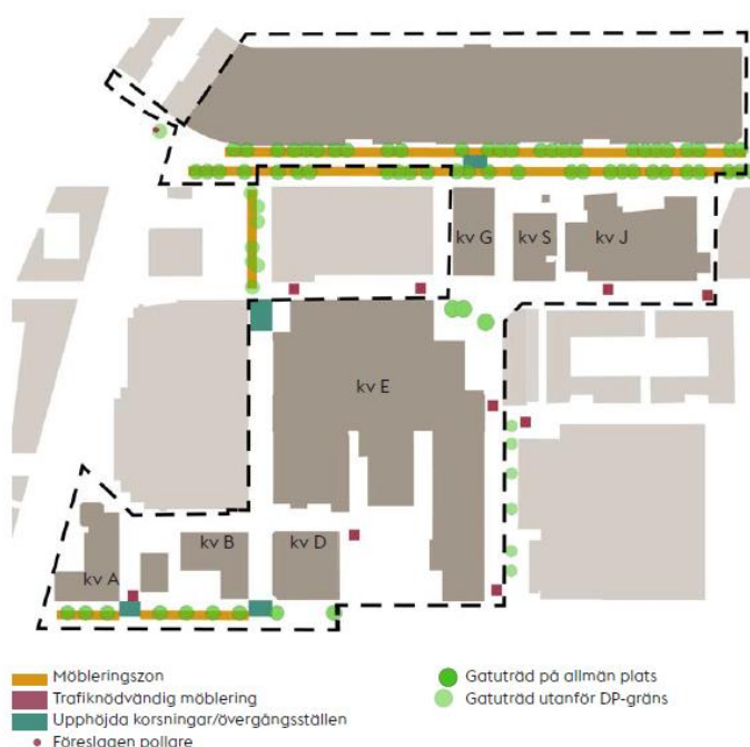
Diagram från Gestaltungsprogram för allmän plats som visar åtgärder för att öka säkerheten genom fasta hinder och fartdämpande, upphöjda korsningar. Bild: Nyréns
