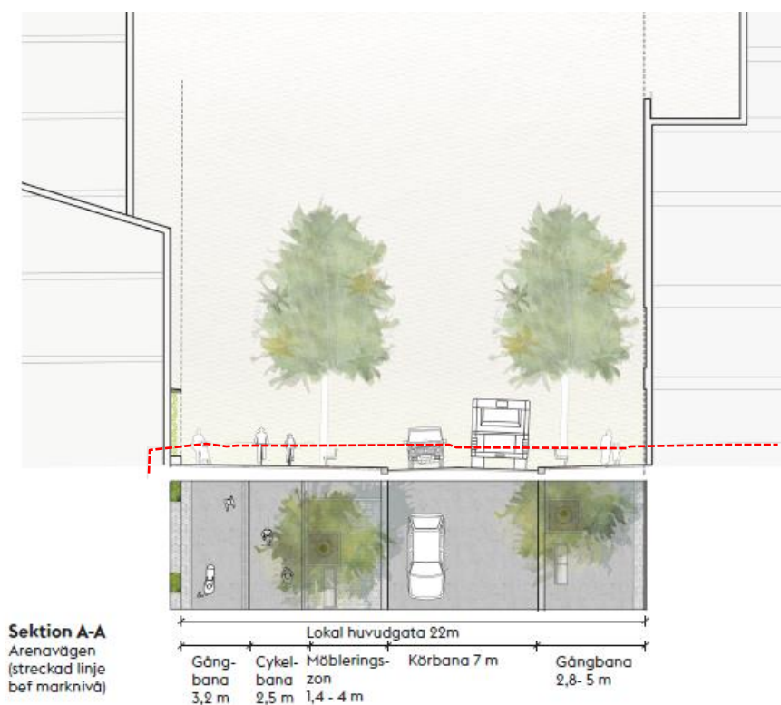
Sektion genom Arenavägen med kv Arenan 2 till höger i bild. Röd streckad linje visar befintlig marknivå. Bild: Nyrens
