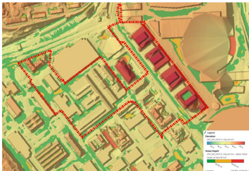
Nulägesmodellering: Beräknade maximalt vattendjup vid ett klimatkorrigerat 100-årsregn. Gröna ytor har max 20 cm vatten, gula ytor mellan 20 och 50 cm. Bild: Sweco
