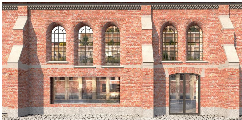
Nya håltagningar för fönster och entré i fasad mot söder
