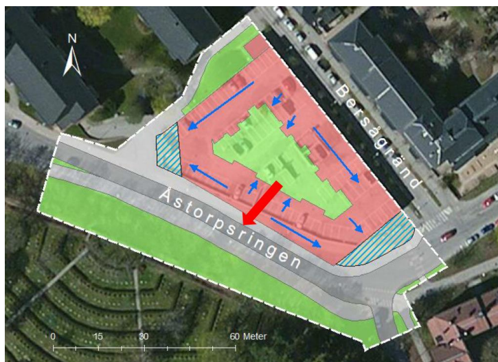
Principskiss som redovisar ungefärlig placering av makadammagasin (blåstreckad yta). Röd pil visar ytlig avrinningsväg för dagvatten genom portiken vid extremregn. Bild från dagvattenutredningen.
