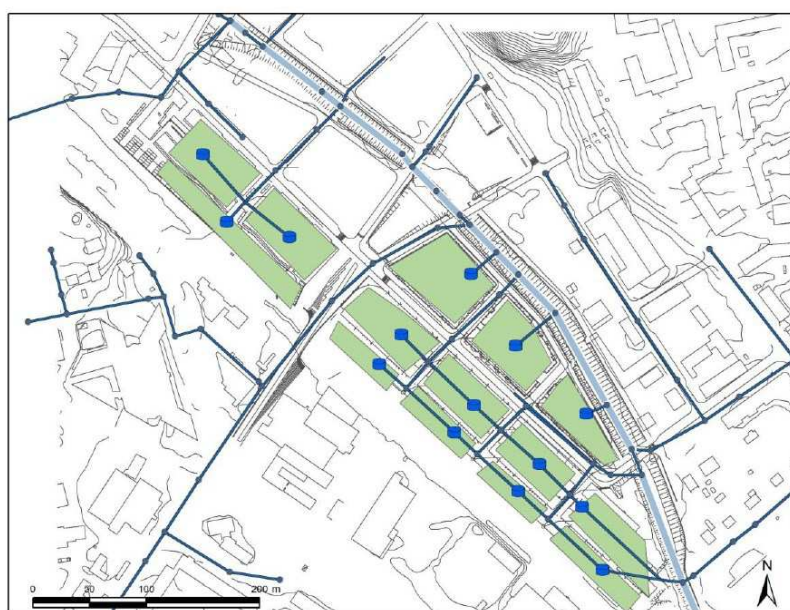
Lokal beräkningsmodell för avrinning och dagvattensystem i kvarteren Gunhild och Gustav, Bromstensstaden
