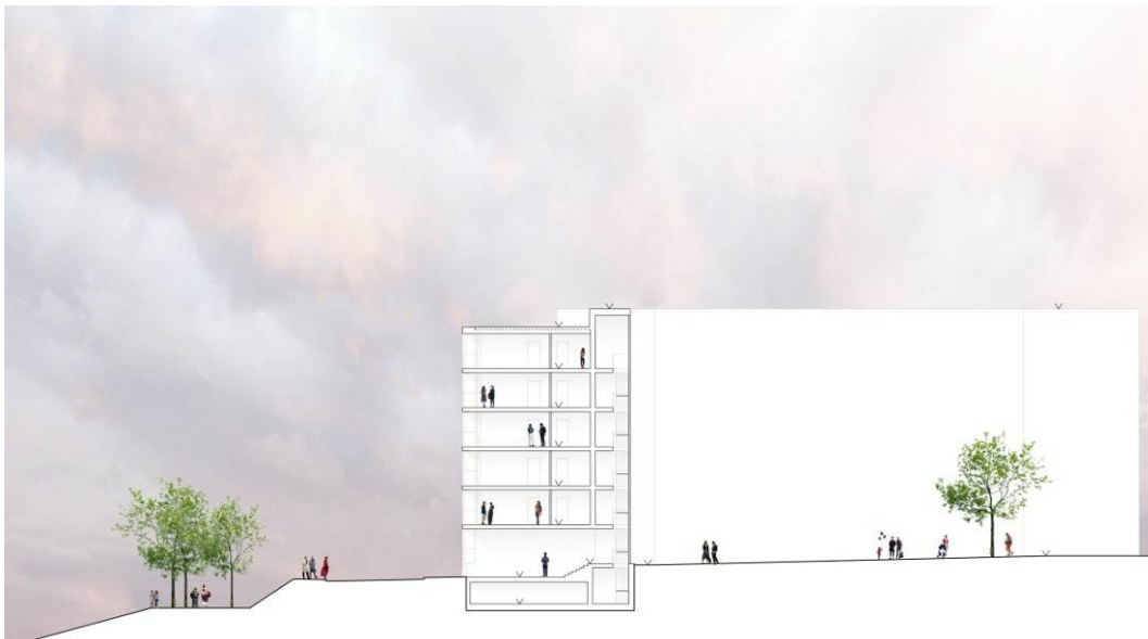
Hus 5 – sektion genom trapphuset. Källarplanet ligger på +2,8 m. Källarvåning ligger lägre än Mälarens uppskattade maxnivå, +2,82 m därför utförs den med vattentät konstruktion. Illustration Arkitema.
