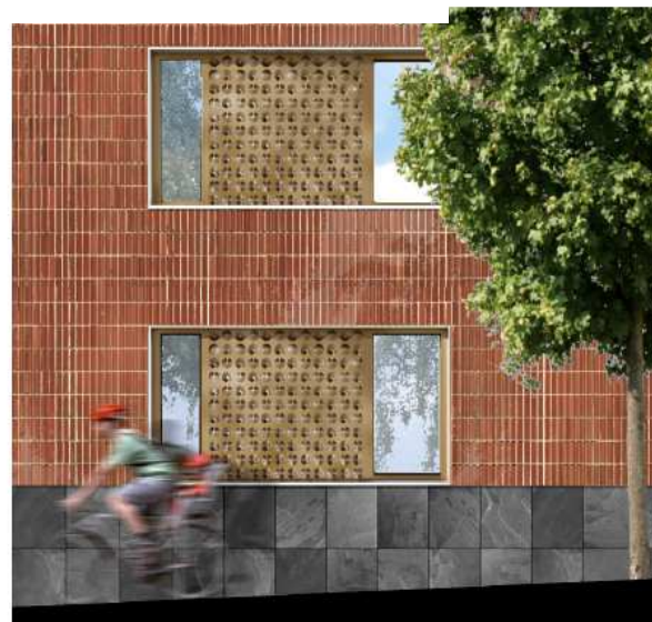
Fasaddetalj sockel glaserat eller engoberat mörkrött tegel med ljus fog. Ramar kring fönstren utförs i ljus plåt, och fönsterfyllningar i mörk plåt som är präglad eller bearbetad. Sparksockel i mörka schifferstenplattor.
