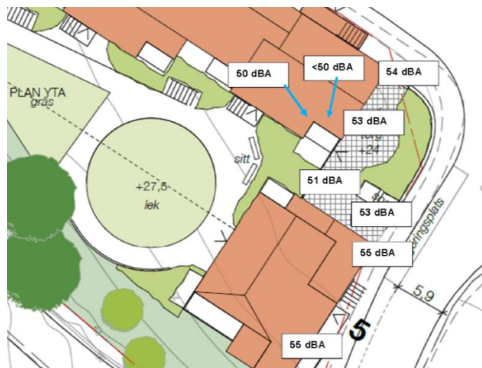
Utdrag ur bullerutredning. Av bilden framgår ekvivalenta bullernivåer för de mest bullerutsatta fasaderna på flerbostadshusen.
