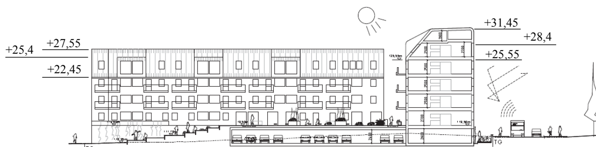
Öst-västlig sektion genom hus A2 som visar det underbyggda garagets utbredning västerut. I sektionen syns gårdsfasad för hus A1. (Witte Arkitektstudio)
