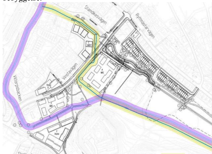
Befintliga och planerade elledningar inklusive 10 meter skyddsavstånd. Bild: WSP.
