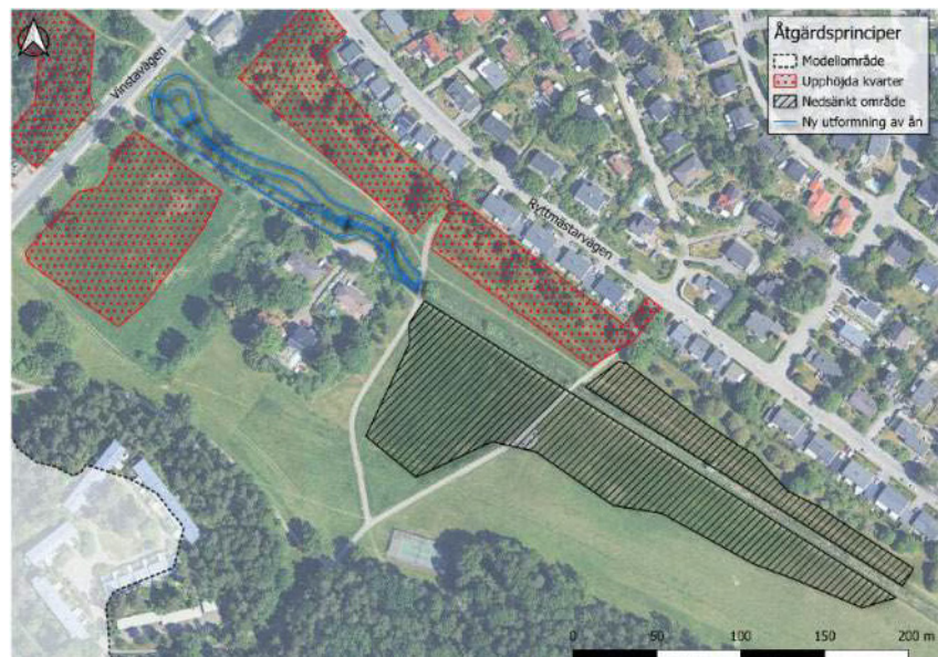
Åtgärder för skyfall i form av nedsänkta ytor (svart) och upphöjda kvarter (rött) samt ny åfära (blått). Bild: Ramboll.
