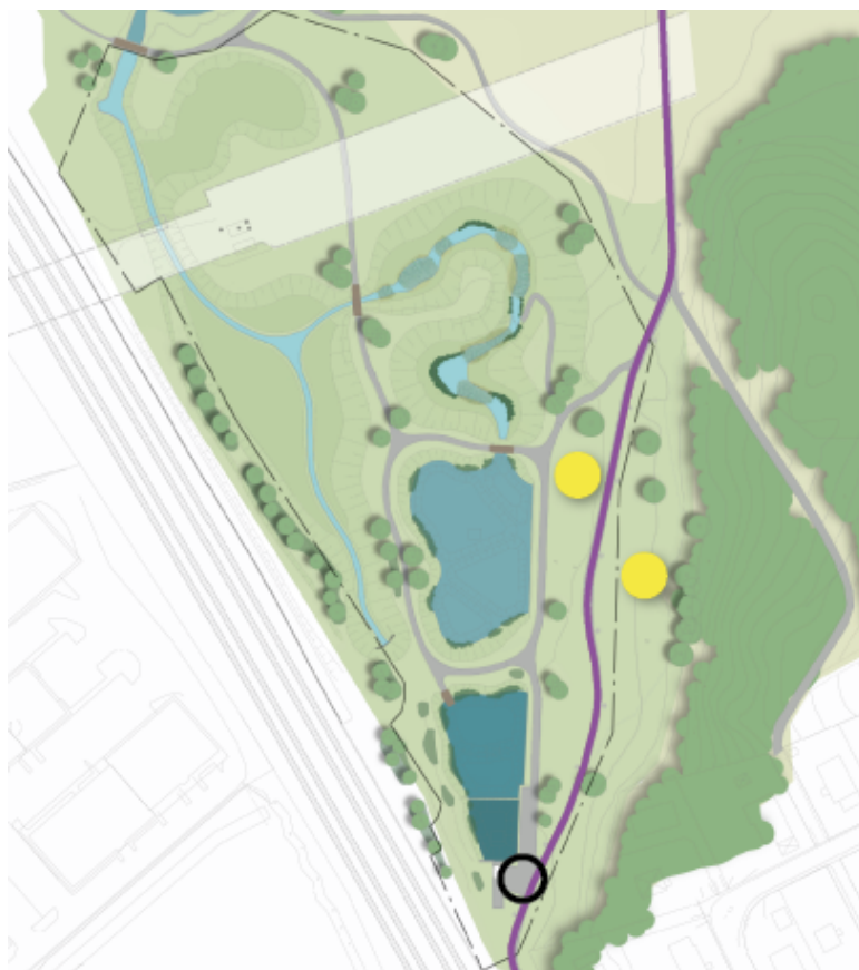
Illustration över befintligt gång- och cykelstråk (lila linje) samt uppställningsplats och vändyta för driftsfordon (svart cirkel). Gula markeringar är föreslagna alternativ för placering av geotuber vid muddring av dammarna.
