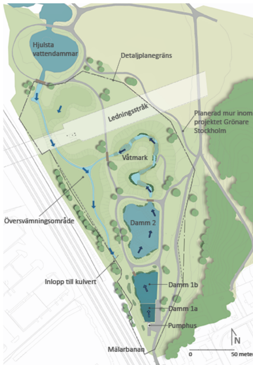
Möjlig utformning av dammar och översvämningssyta. Pilarna visar vattnets flödesriktning (Ramboll, 2023).
