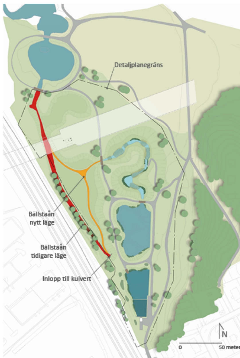
Illustrationsplan med Bällstaåns befintliga sträckning markerat med rött och dess föreslagna sträckning markerat med orange. Detaljplanegräns är markerad med grå streckad linje. (Ramboll, 2023).
