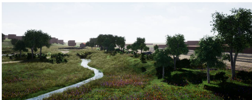
Projekterad lösning. Åfåran har flyttats för att öka avståndet till Mälarbanan samt för att skapa fördröjningsvolym med flacka slänter. Vy mot söder med kulvertens öppning i bakgrund (Ramboll).
