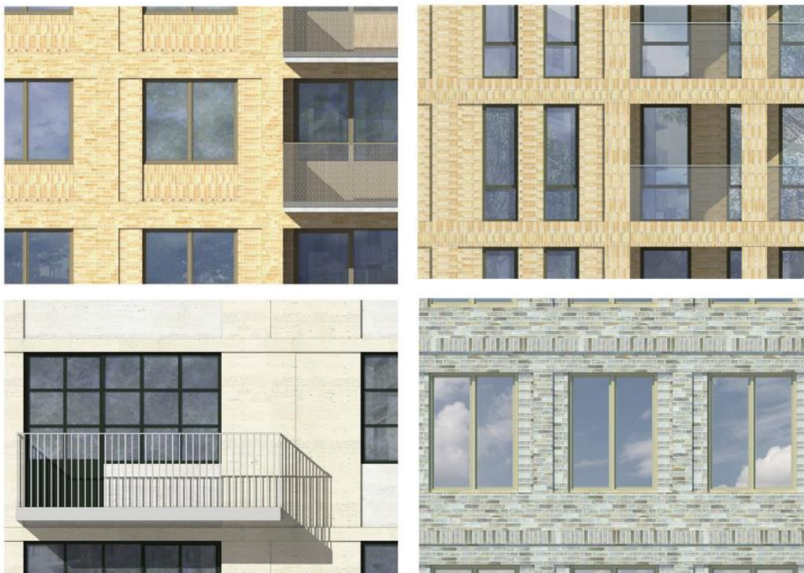
Fasadutsnitt, murning, detaljer, reliefer, balkonger (AIX Arkitekter)
