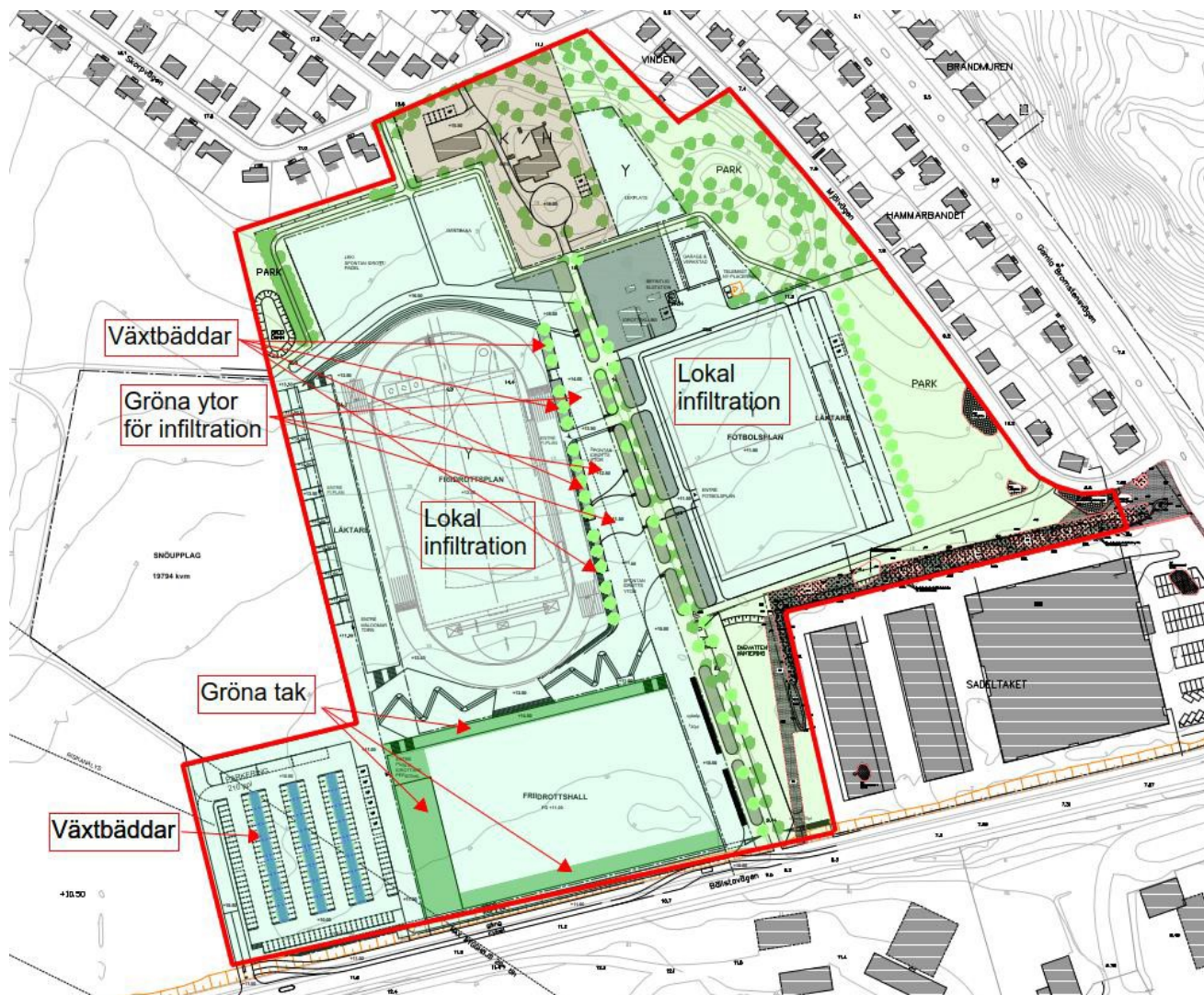
Bild 20. Föreslagen generell placering av dagvattenanläggningar i området.
