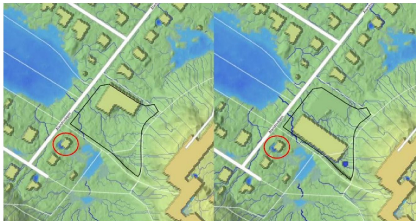
Befintlig avrinningsväg (t.v.) respektive kommande avrinningsväg (t.h) sydväst om planområdet. Utdrag från dagvattenutredningen.
