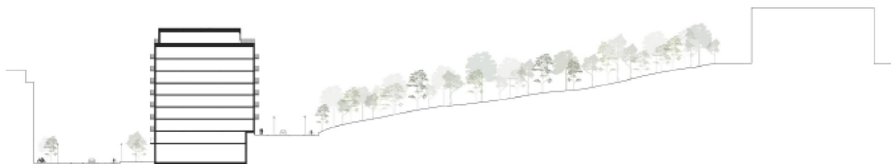
Principsektion genom Hus 4 mot söder med Bobergsgatan på den lägre nivån och Gasverksvägen på den övre, de planerade husen överbryggar nivåskillnaden. CF Möller Architects.
