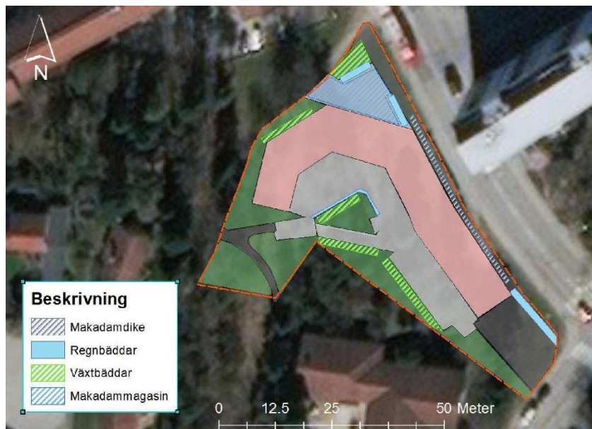
Principskiss för dagvattenlösningar med växtbäddar, makadamdike, regnbäddar och makadammagasin i områdets nordöstra del. Bild: Geosigma.
