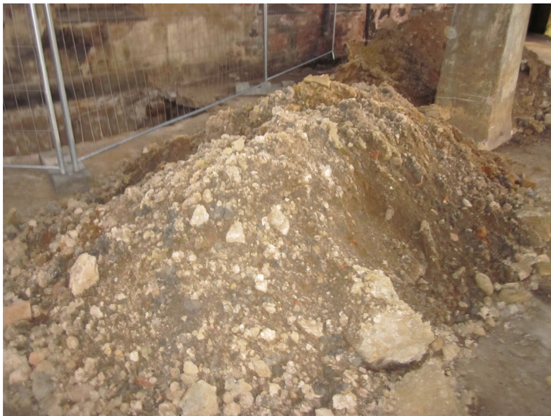
Hus 9 (SLs projekt, provgropar) – Exempel på fyllnadsmassor
