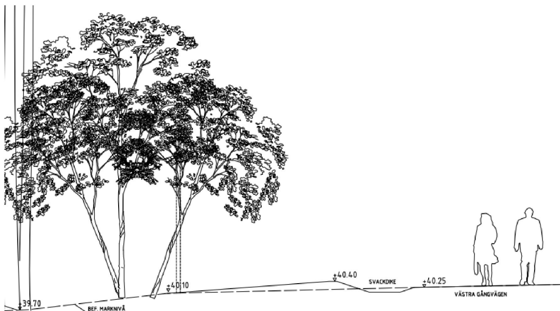
Figur 6 Placering och utformning av svackdike längs västra gångvägen.
