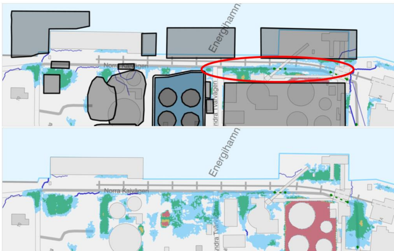
Figur 8. Ytliga flödesvägar och skyfallsvolymer längs Norra Kajvägen (Scalco Live, 2025). I bilden under visas befintlig höjdsättning, i bilden ovan har planerad höjdsättning simulerats. Röd cirkel markerar den mest påtagliga skillnaden mellan befintligt-planerat.
