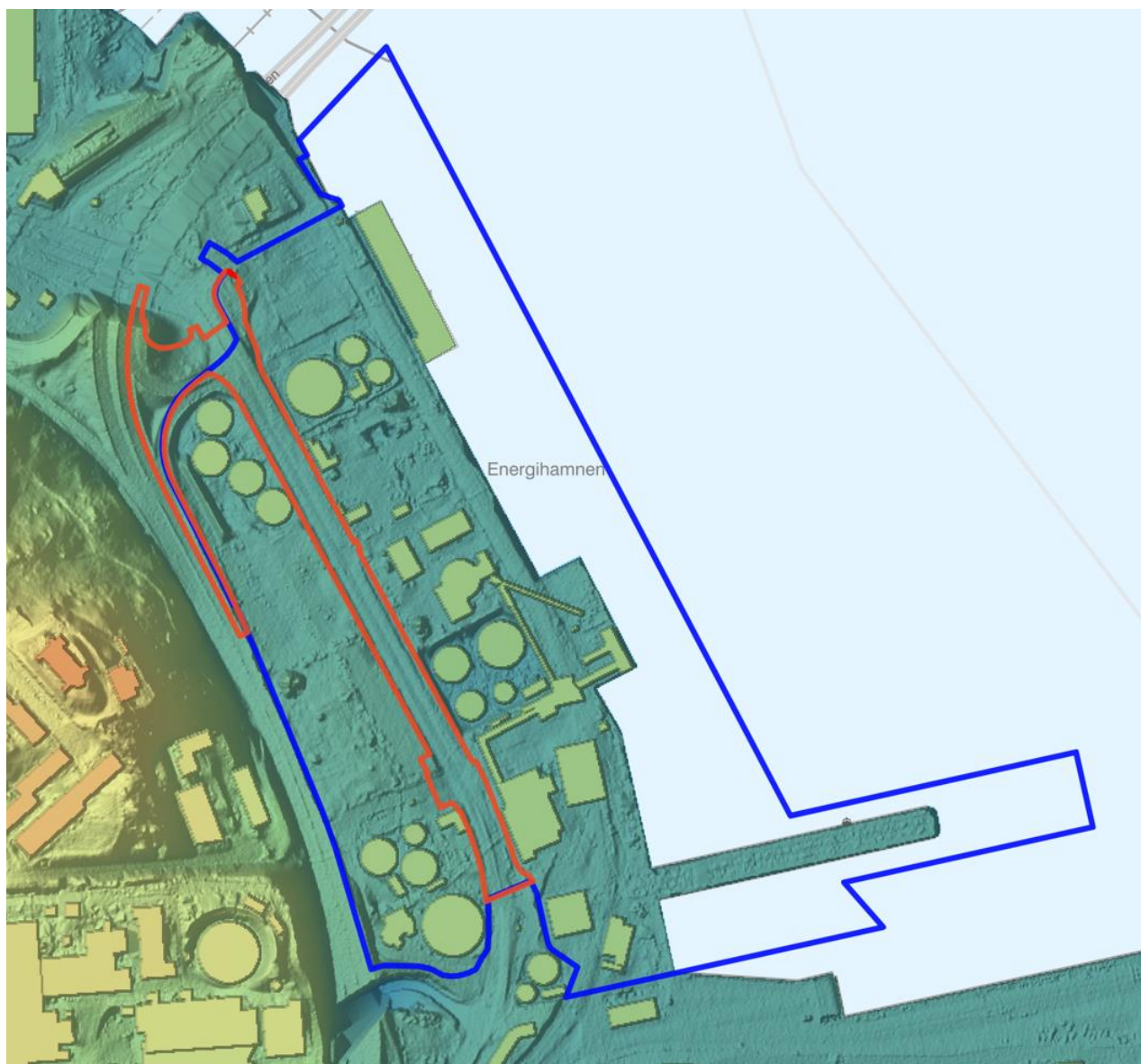
Figur 1. Karta över områdets befintliga situation som omfattas av dagvattenprojekteringen – Norra Hamnvägen (Scalgo Live 2024). Röd linje visar systemhandlingsgränsen för projektet. Blå linje visar gränsen för detaljplan.
