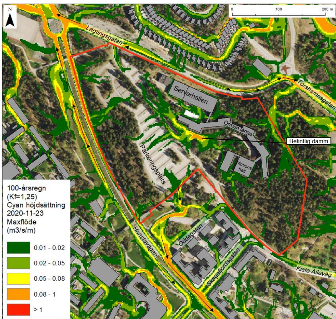
Figur 7. Maximalt flöde (m³/s/m) som uppstår innan exploateringen vid 100-årsregn med klimatkfaktor 1,25. Den befintliga dammen är utpekad. Svarta pilar motsvarar vattnets avrinningsriktning. Se Figur 20 för ett större bildutsnitt.
