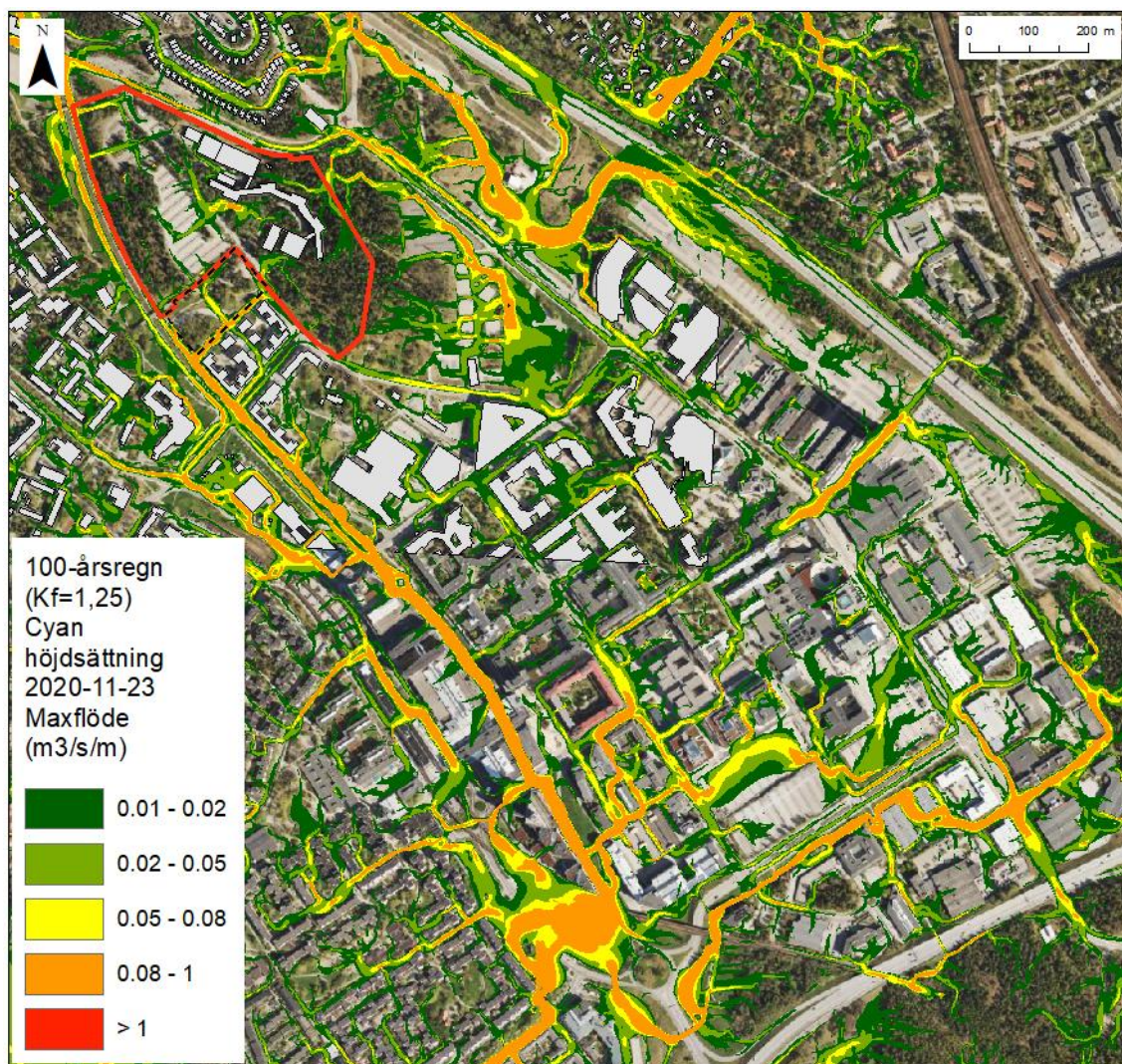
Figur 19. Flödesvägar när både kv.Odde och Kista Gård 2 är utbyggda.
