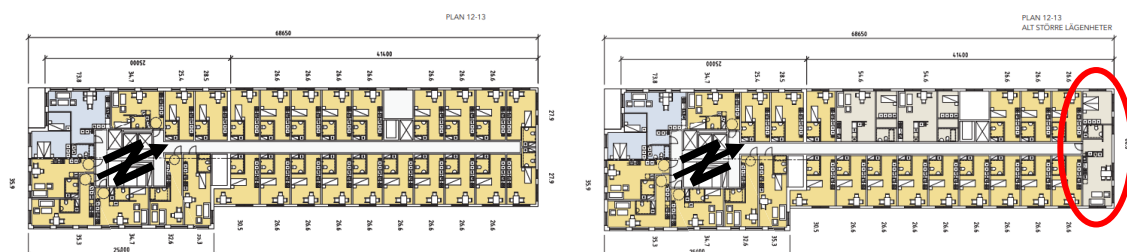
Figur 3. Två alternativa planlösningar för den södra huskroppens sockelbyggnad. Vänstra bilden: grundalternativ (klarar trafikbullerriktvärden vid fasad). Högra bilden: "alt. större lägenheter" (klarar inte riktvärdena vid inringad gavellägenhet).
