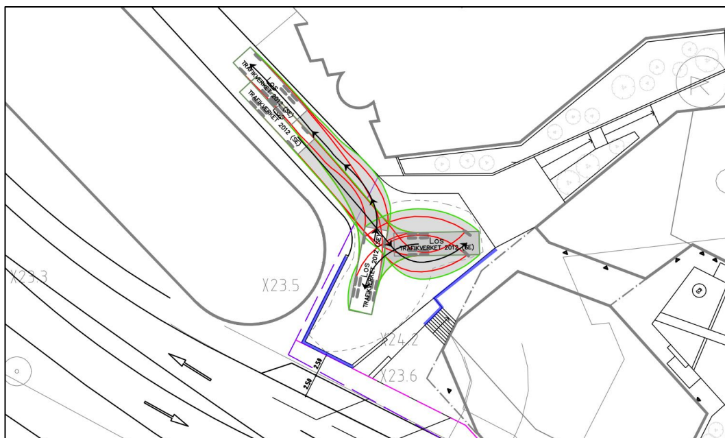
Figur 4-6 Körspåren visar hur en sopsbil backar en fordonslängd för att vända. Blå linjer markerar räcken som styr gående bort från området där backning med lastbil förekommer.
