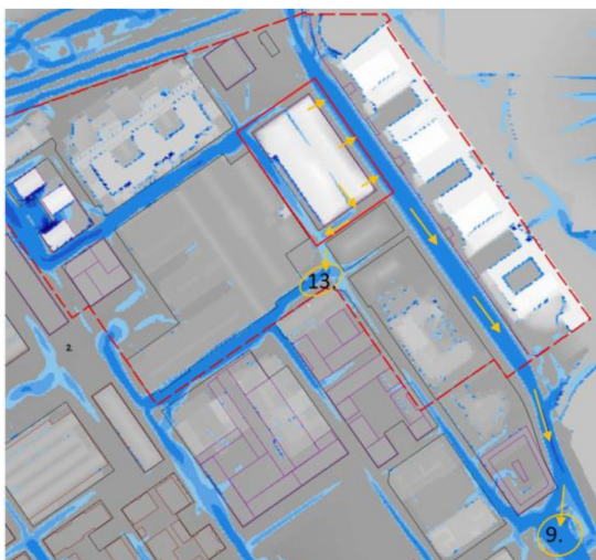
Figur 11 Om inte Dp2a eller Dp4a antas och eller under byggtiden innan Dp2a och Dp4a färdigställs kan skyfallsvattnet från Dp2d hanteras dels i en lågpunkt på Styckmästargatan, nr: 13 och dels i en lågpunkt på Evenemangstorget, nr: 9.
