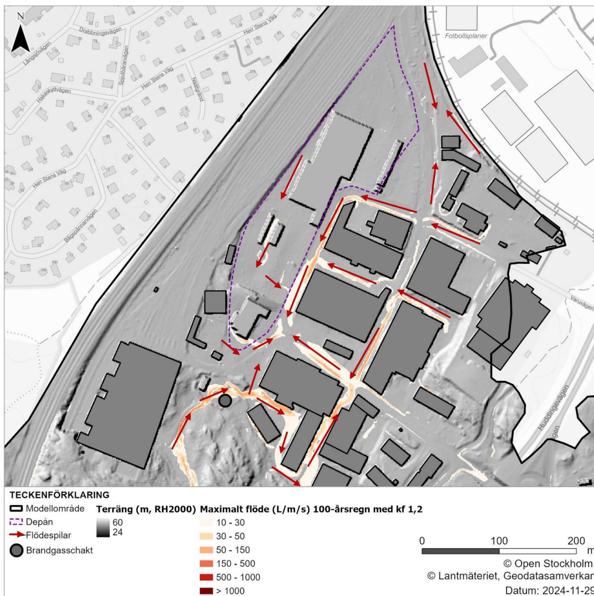
Figur 10. Inzoomad karta på maximalt flöde (L/m/s) vid depån för modellerat 100-årsregn med klimatkfaktor 1,2 i befintlig situation. Depån är planförslaget ovan mark, se Figur 1 för hela planförslaget.
