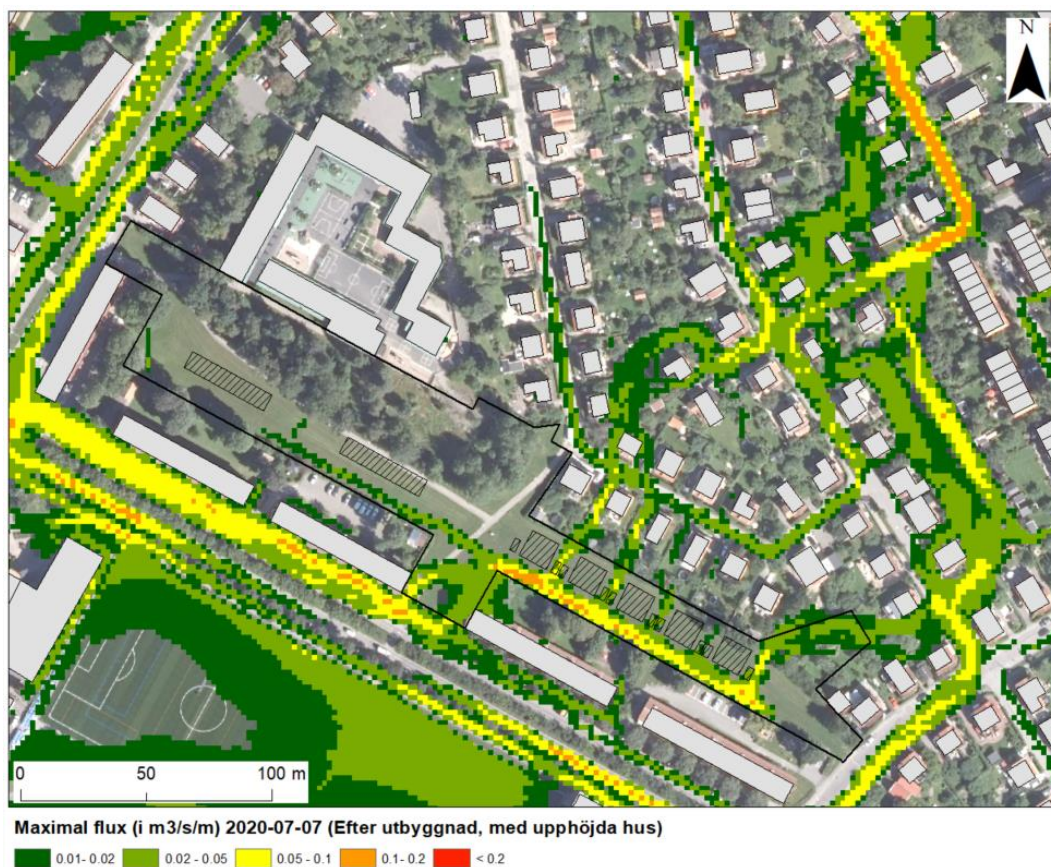
Figur 10. Maximalt flöde (m³/s/m) vid 100-årsregn med klimattfaktor 1,25, efter utbyggnad med optimerat flödeskapacitet mellan parhusen.
