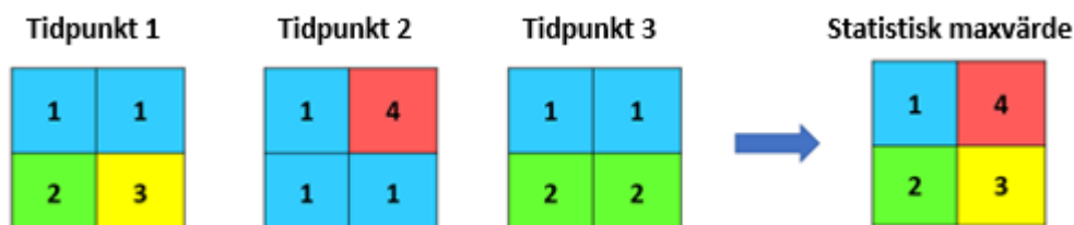
Figur 5. Princip för hur statistiskt maxvärde bestäms under modellsimuleringen.
