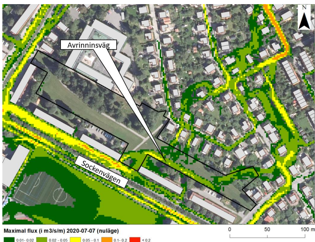
Figur 9. Maximalt flöde (m 3 /s/m) vid 100-årsregn med klimatfaktor 1,25, nuläge.
