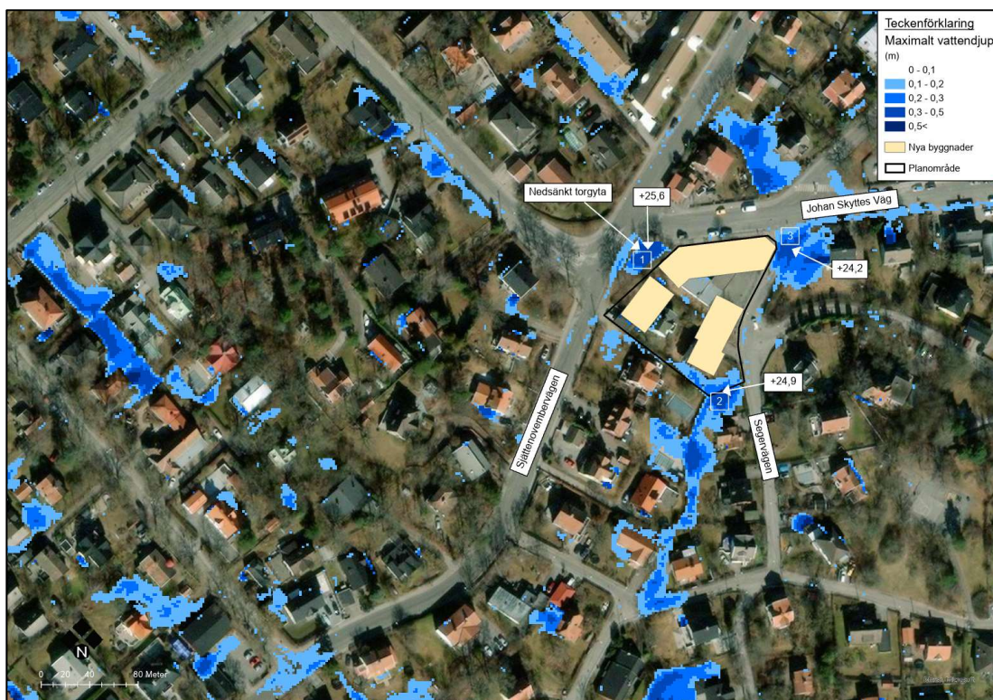
Figur 6:1. Resultat med maximala vattendjup från simulering vid ett 100-årsregn med 30 minuters varaktighet och klimatkraft 1,25. Lågpunkterna har numrerats 1-3.
