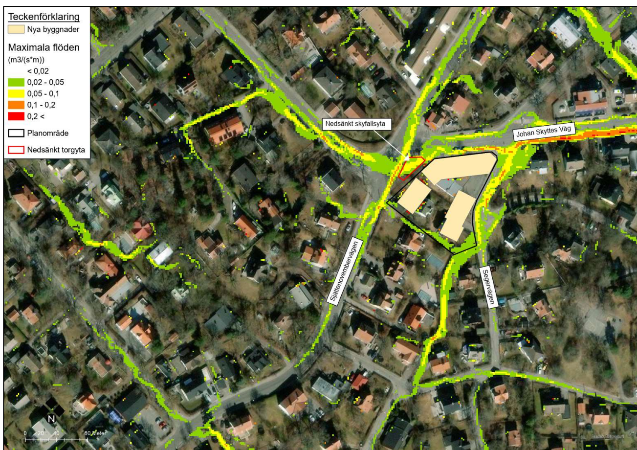
Figur 6:5. Maximala flöden vid ett 100-årsregn med 30 minuters varaktighet och klimattfaktor 1,25
