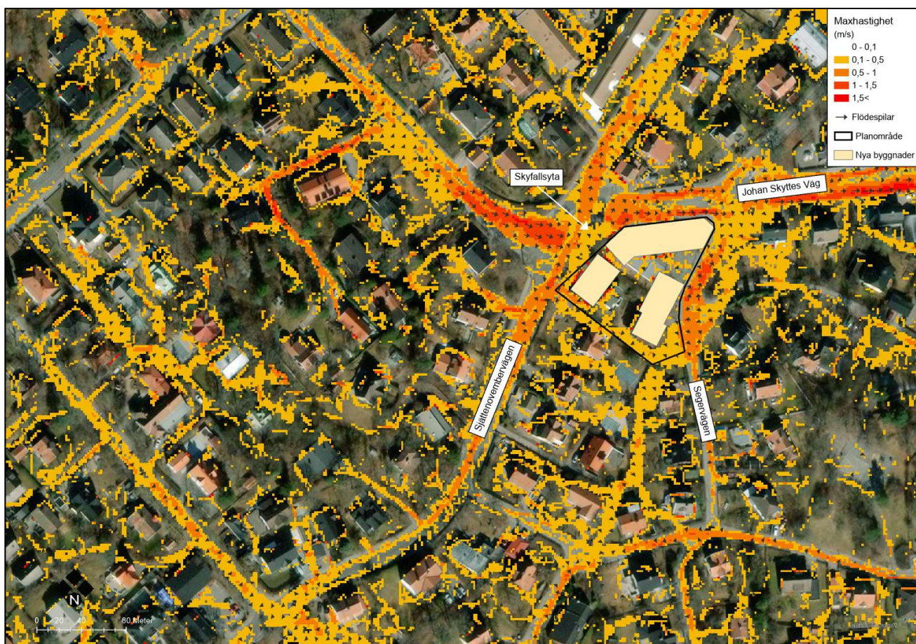
Figur 6:4. Maximala vattenhastigheter vid ett 100-årsregn med 30 minuters varaktighet och klimatkfaktor 1,25.
