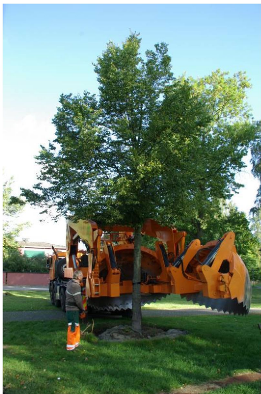
Figur 1. Träd tas upp och transporteras till ny växtplats med en specialbyggd lastbil anpassad för att flytta större träd. Bilderna är tagna i Kristianstad 2013. Foto Örjan Stål.
