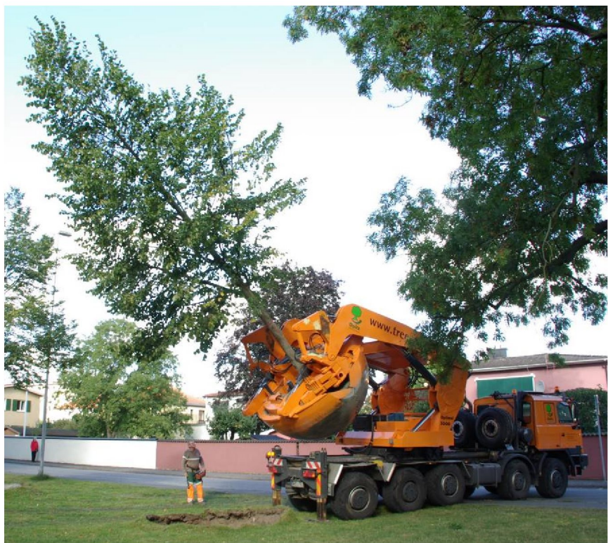
Figur 1. Träd tas upp och transporteras till ny växtplats med en specialbyggd lastbil anpassad för att flytta större träd. Bilderna är tagna i Kristianstad 2013. Foto Örjan Stål.
