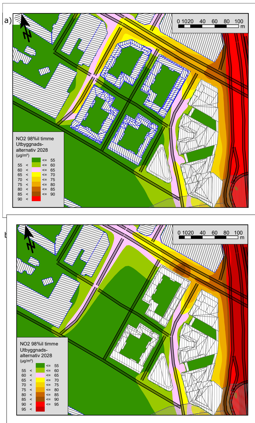
Figur 4. 98-percentil av timmedelvärde avseende \text{NO}_2 ( \mu\text{g}/\text{m}^3 ) för två olika utbyggnadsalternativ år 2028 a) med kvarter 1 - 4, b) med kvarter 3 och 4. Röd haltgräns visar MKN och rosa haltgräns visar MKM.
