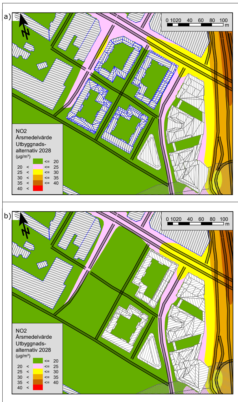
Figur 2. Årsmedelvärdet av \text{NO}_2 ( \mu\text{g}/\text{m}^3 ) för två olika utbyggnadsalternativ år 2028 a) med kvarter 1 - 4, b) med kvarter 3 och 4. Röd haltgräns visar MKN och rosa haltgräns visar MKM.
