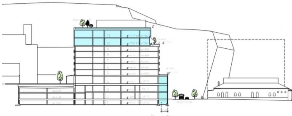
Figur 5. Typsektion befintlig konstruktion och planerad utbyggnad av Globen Shopping.
