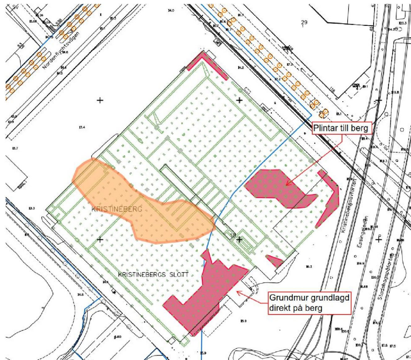
Figur 3 Befintlig grundläggning av bussgaraget.
