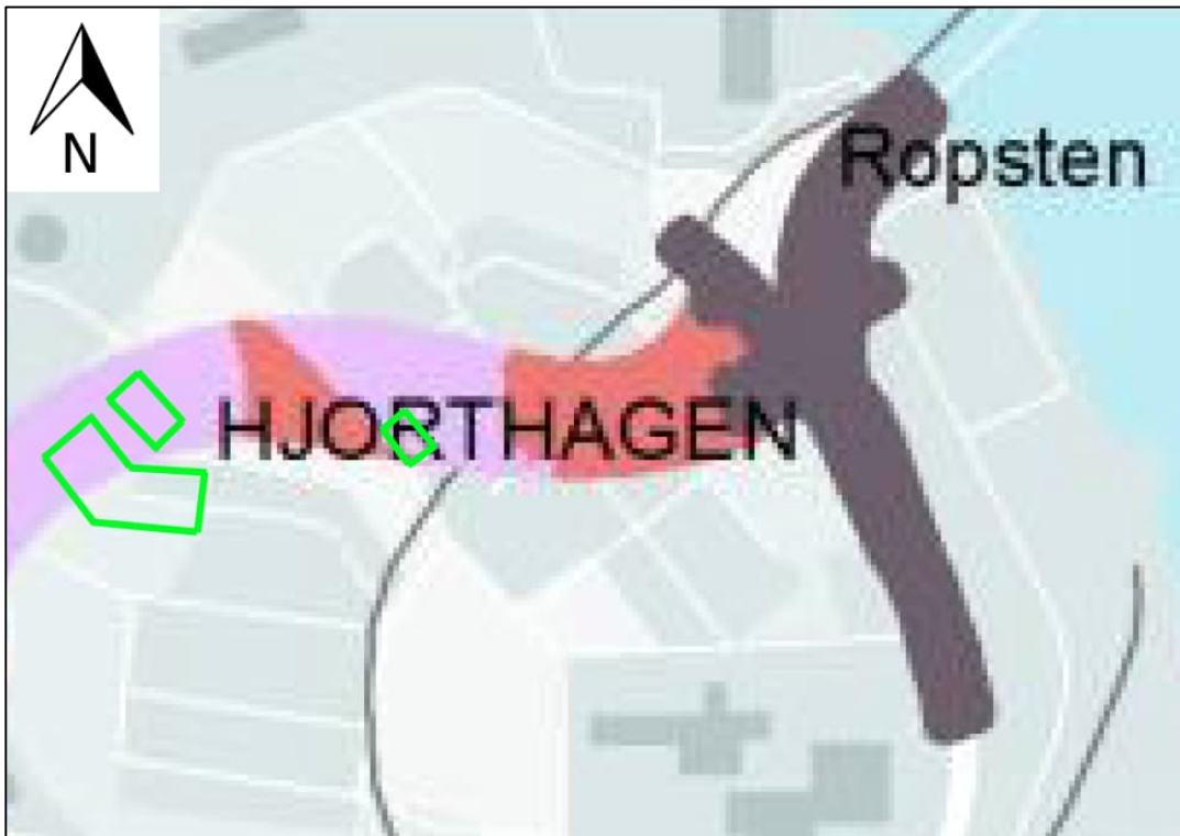
Figur 3.2: Omfattning av det framtida riksintresset Östlig förbindelse inom området. Svarta områden motsvarar anläggningsdelar ovan mark, rosa områden anläggningsdelar där tunneltaket ligger djupare än 25 m under befintlig mark och röda områden anläggningsdelar där tunneltaket ligger mindre än 25 m under befintlig mark. Gröna markeringar visar ungefärliga områden för planerad bebyggelse i anslutning till Östlig förbindelse, jämför med Figur 1.1. Urklipp från [6].
