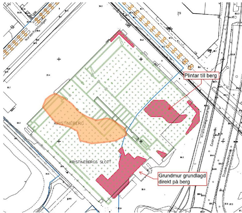
Figur 3 Befintlig grundläggning av bussgaraget.
