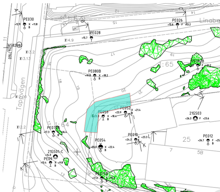
Figur 17. Utfackning utförd så att slänten blir 1:2. 7 meter utfackning utförs från slätkrön.
