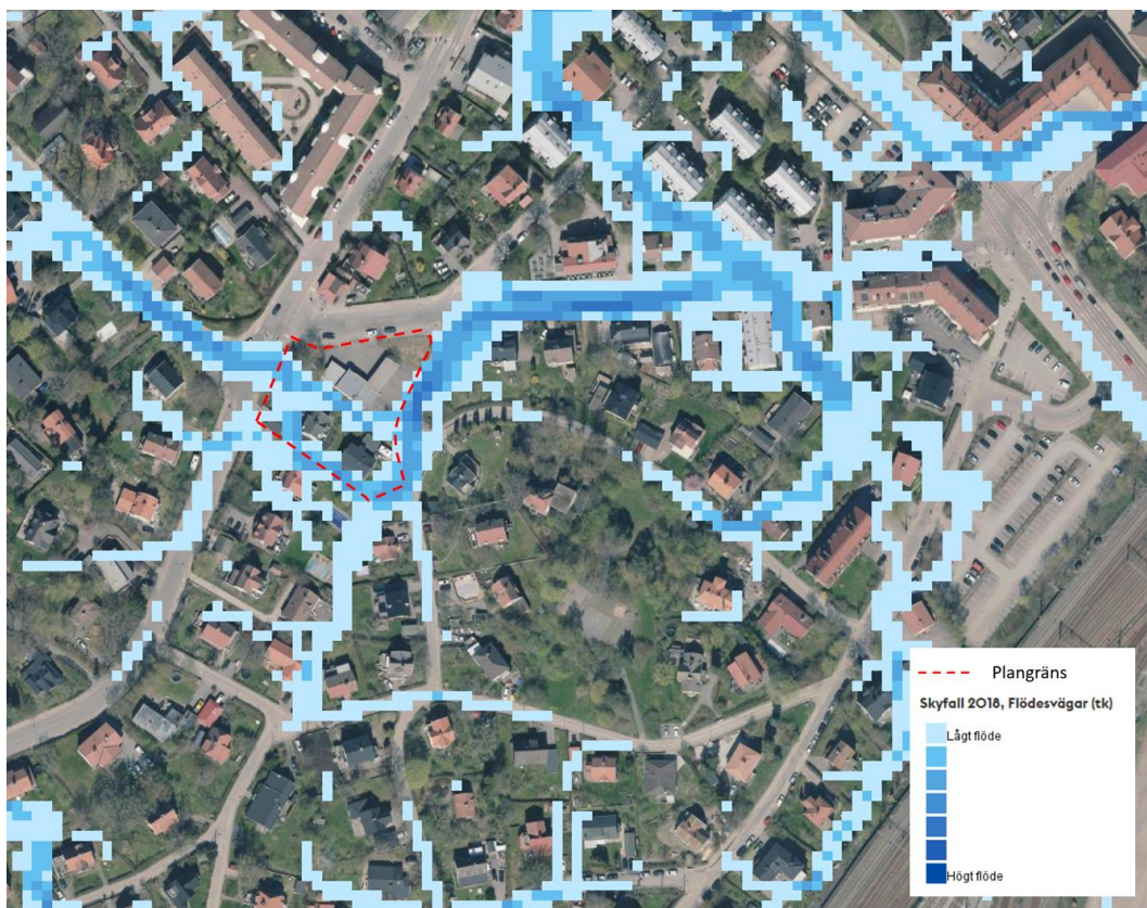
Figur 10. Ett utdrag ur Stockholms Stads skyfallskartering som visar simulerat maxflöde.
