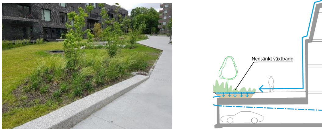
Figur 18. Exempel på nedsänkta växtbäddar för omhändertagande av t.ex. takdagvatten.
