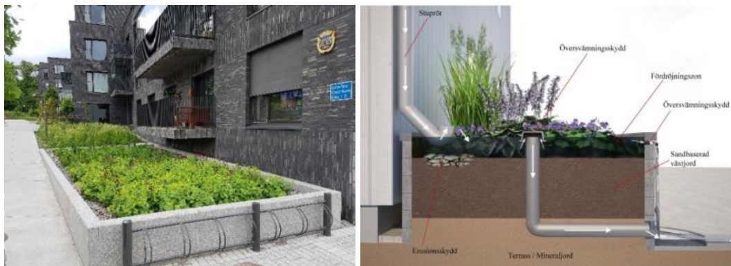
Figur 17. Exempel på växtbäddar för omhändertagande av t.ex. takdagvatten.
