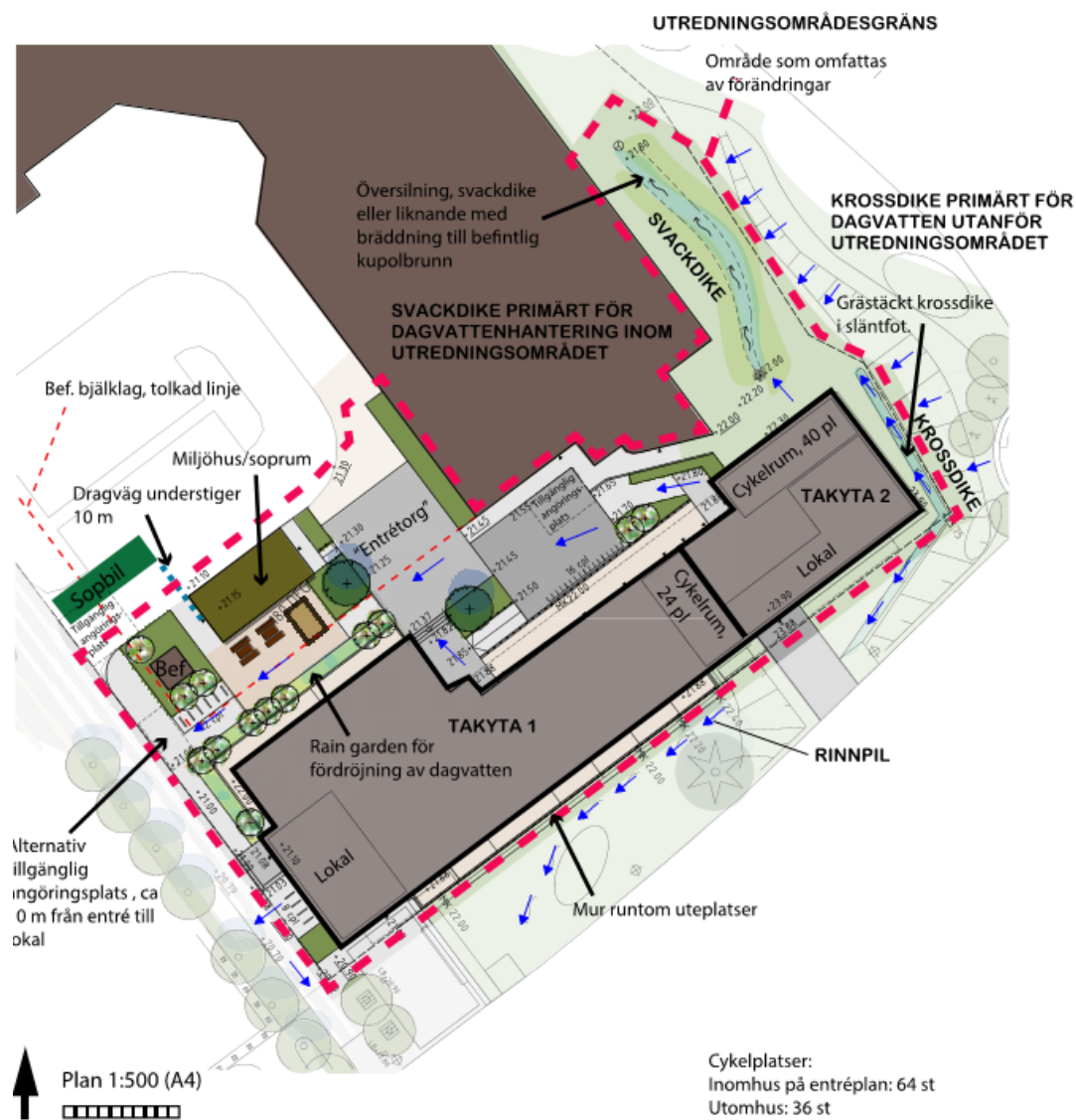
Figur 14. Utredningsskiss, markplanering med föreslagna dagvattenåtgärder, Bjerking 2021-09-02
